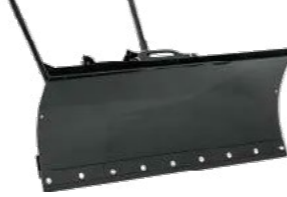
SNÖPLOGSBLAD Arbetsbredd 125 cm Fjäderassisterat fällbart plogblad 5 inställbara positioner Plogkant med gummillist som skonar underlaget
