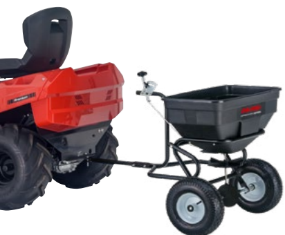
SPRIDARE SP 60* Kapacitet: 56 l Spridningsbredd: 2 – 5 m
